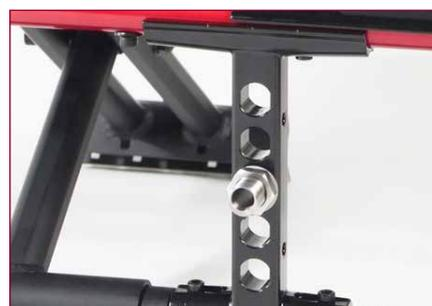
Ajuste en profundidad de 41 a 51 cm, camber de las ruedas traseras a 0° o 3° y del centro de gravedad (-5 cm a +7,5)
