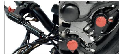
Frenos mecánicos Avid BB5. Rotor de disco Avid G2 de 140mm. Freno de aparcamiento.
