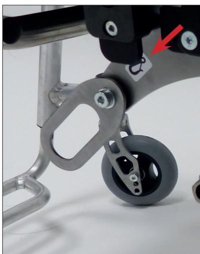
Puntos de fijación delanteros según ISO 7176-19
