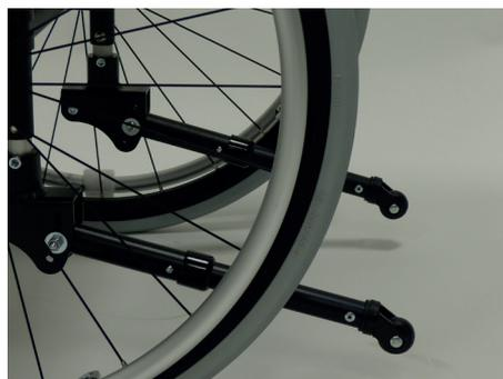
Presione el botón de presión y elija la posición de longitud deseada. La longitud de los tubos antivuelco se puede ajustar en el soporte antivuelco en tres posiciones a 2,5 cm de distancia.
