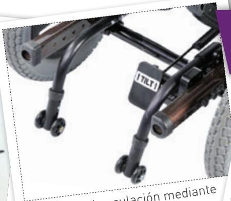
Opción de basculación mediante pedal. Facilita el uso y además elimina el cableado.
